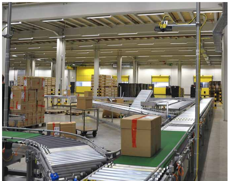
In der Logistik ist Zuverlässigkeit und Zeit ein entscheidender Faktor. Stationäre ID-Lesegeräte DataMan 500 von Cognex lesen mit hoher Flexibilität die Barcodes auf den in der Höhe variierenden Paketen.
