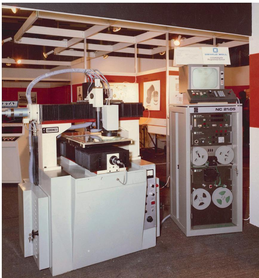
Leiterplattenbohren anno 1972: Die Steuerung setzt neue Maßstäbe.
