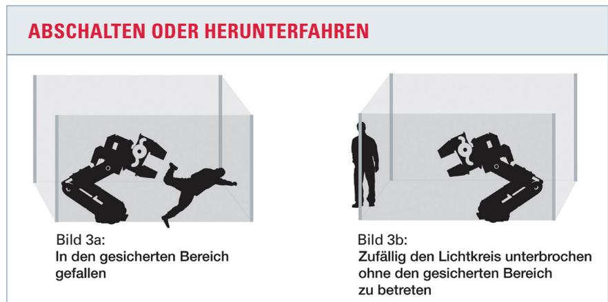
Bild 3a: In den gesicherten Bereich gefallen
